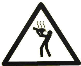
Рис. 4.1 Наклейка «Опасность ошпаривания»
