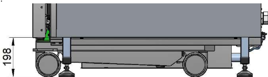
Рис. 5 Установка пароконвектомата – просвет между полом и основанием пароконвектомата
