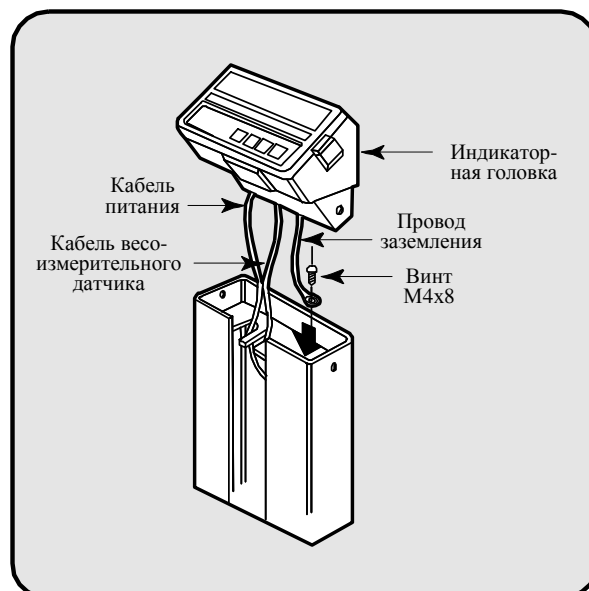
Рисунок 4.2 – Подключение заземления
